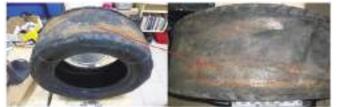
Рис. 5. Локальна зона на оголеній сітці сталевго брекера, яка відрізнялася наявністю корозії та стиранням металевих ниток та шару гуми
